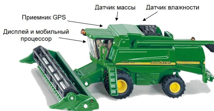
Рисунок 8.3 – Комбайн, оснащенный оборудованием для картирования урожайности
