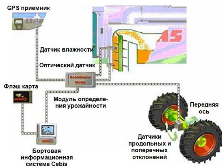
Рисунок 8.1 – Система картирования урожайности
